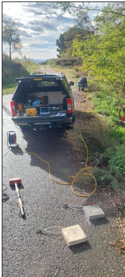
Posizionamento Sism e MASW 4
