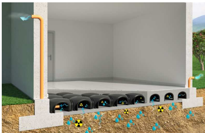
Figura 3: fondazione con vespaio aerato mediante casseri del tipo igloo
