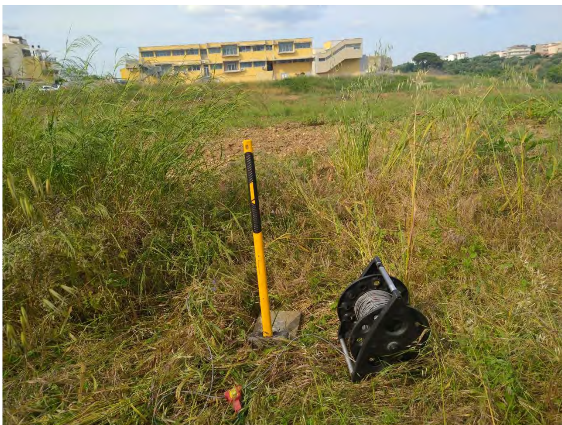
Fasi di acquisizione della prospezione sismica a rifrazione SR2 e MASW/Re.Mi.
