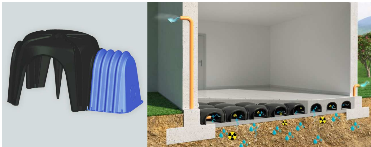
Figura 10_fondazione con vespaio aerato mediante casseri del tipo igloo (illustrati a sinistra)
