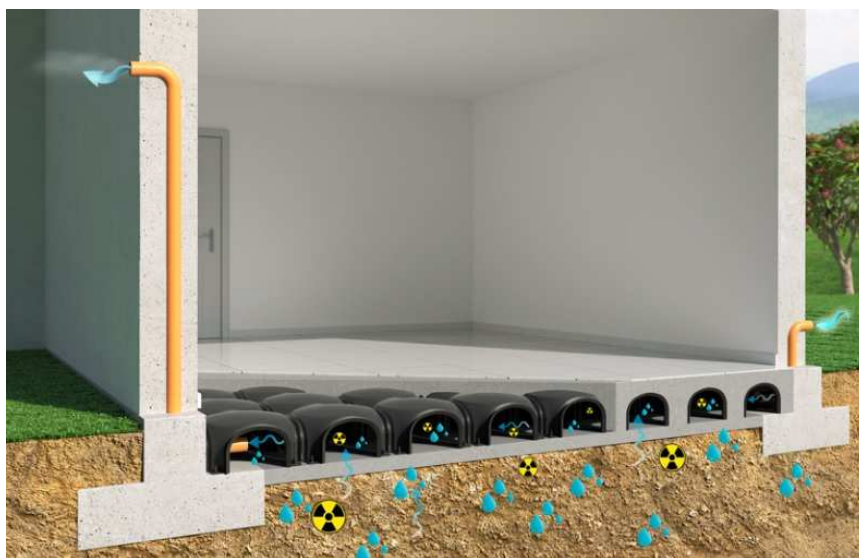
Figura 31_fondazione con vespaio aerato
