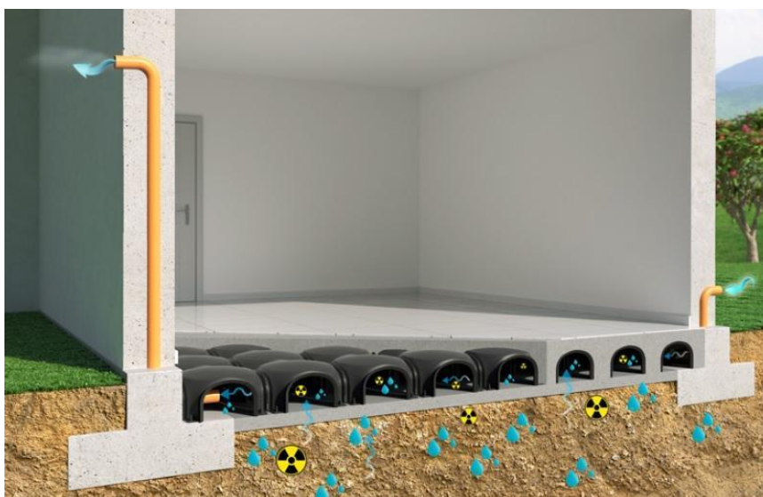
Figura 3_fondazione con vespaio aerato
