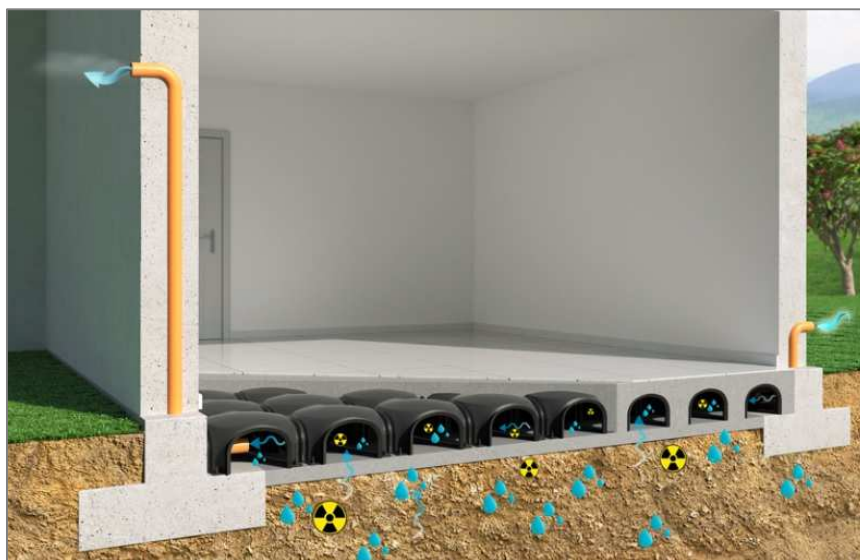
Figura 14_fondazione con vespaio aerato
