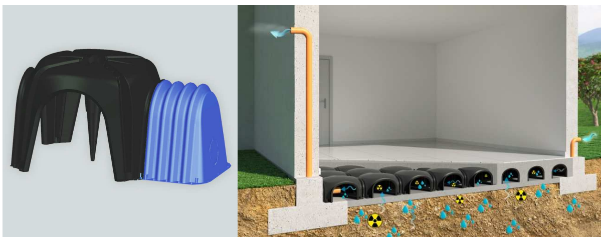
Figura 20 Fondazione con vespaio aerato mediante casseri del tipo igloo (illustrati a sinistra)
