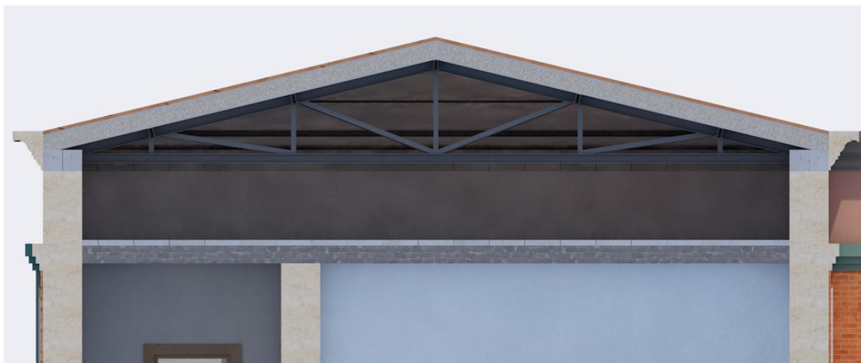
Figura 18: Nuova copertura metallica
