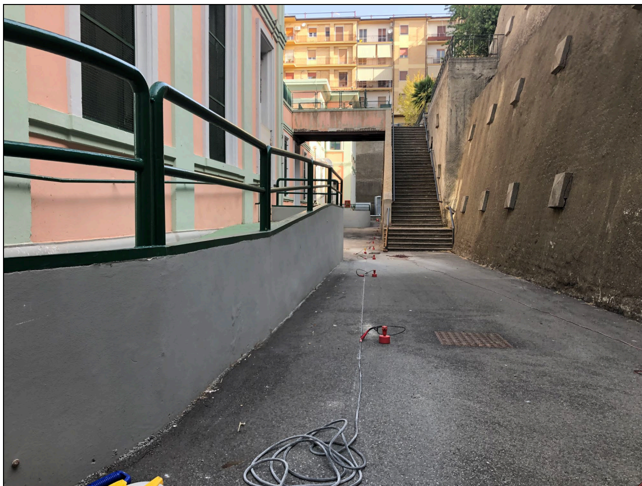
Fig. 19 – Indagine sismica a Rifrazione di superficie in onde P (Tomografia TS1) sul prospetto posteriore
