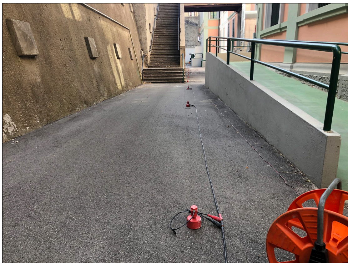
ALLEGATO 6 – Documentazione Fotografica indagini geofisiche (MASW M1 - TOMOGRAFIA SISMICA TS1)
