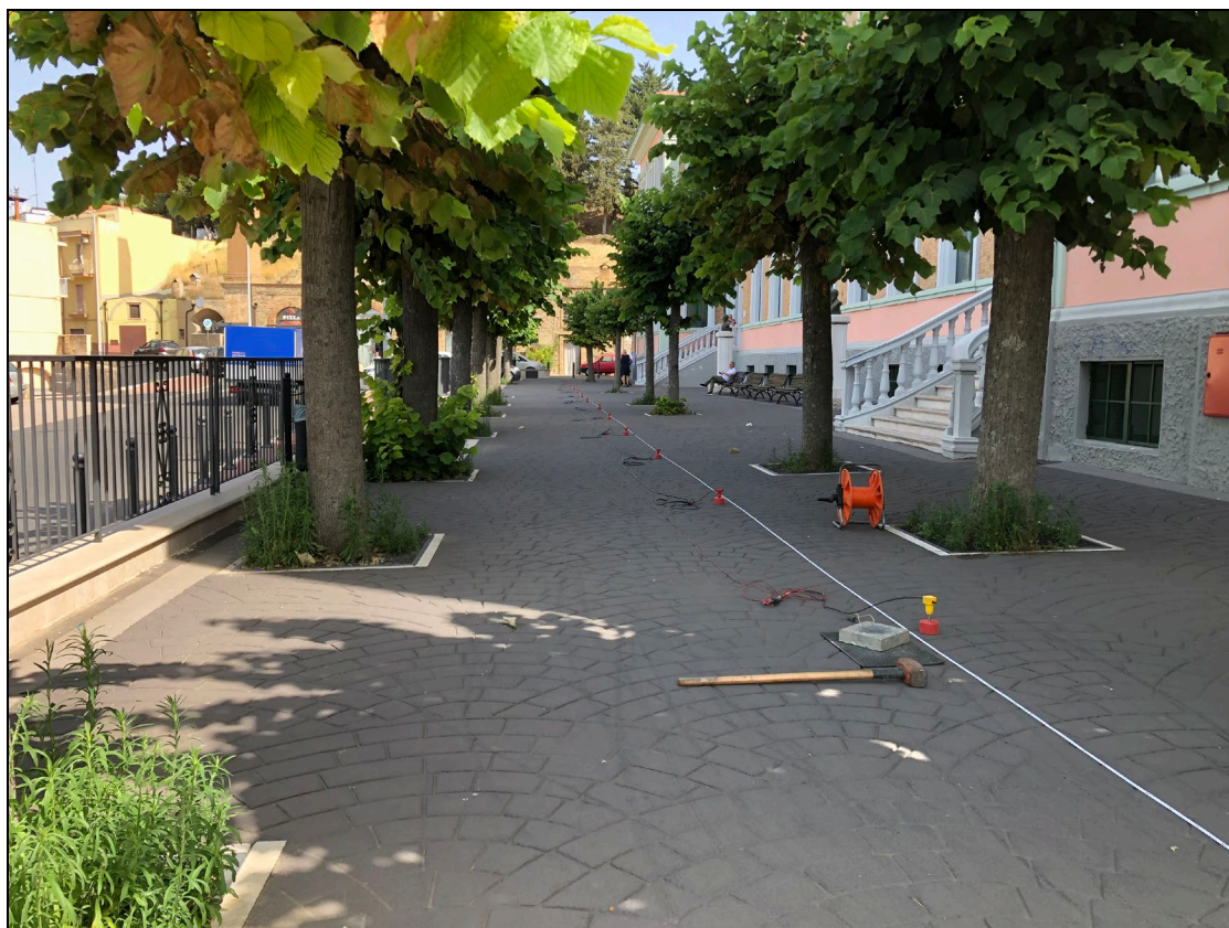
ALLEGATO 6 – Documentazione Fotografica indagini geofisiche (MASW M2 - TOMOGRAFIA SISMICA TS 2 )
