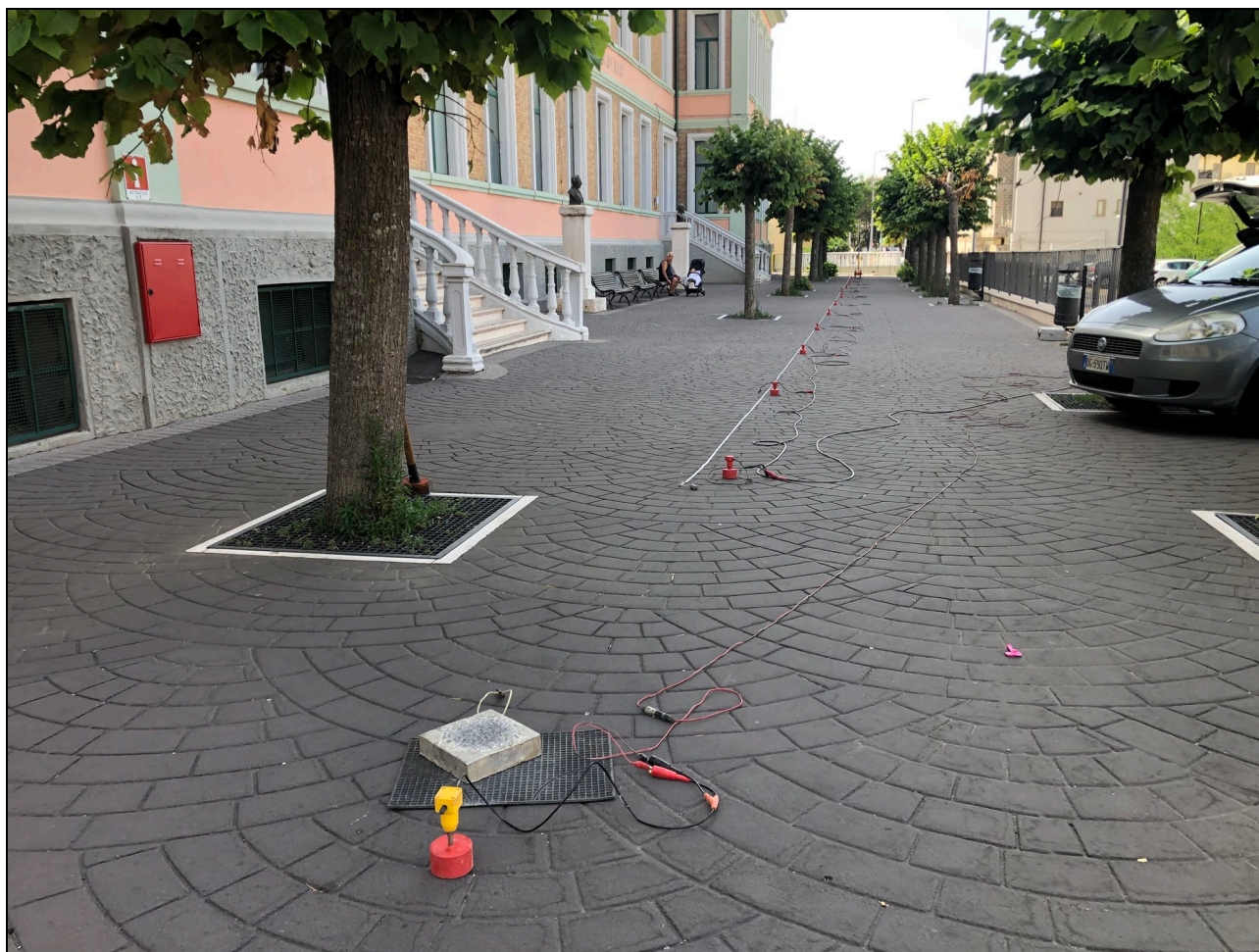
Fig. 20 – Indagine sismica a Rifrazione di superficie in onde P (Tomografia TS2) sul prospetto anteriore
