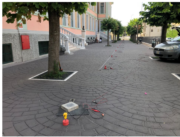
Figura 11: Indagine sismica a Rifrazione di superficie in onde P (Tomografia TS2) sul prospetto anteriore
