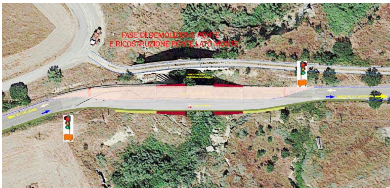
Traffico sulla nuova corsia e demolizione dell'attuale ponte con costruzione della corsia di monte
