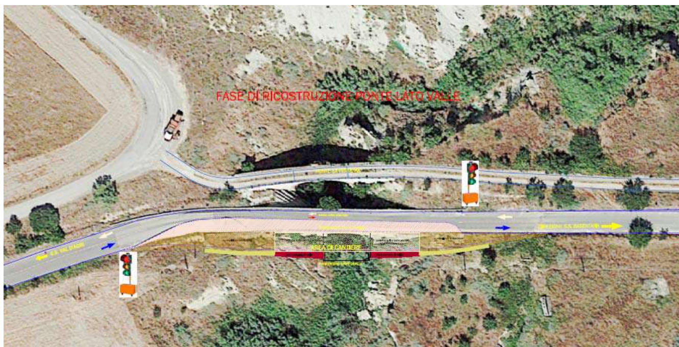
Traffico sull'attuale ponte e costruzione della corsia di valle
