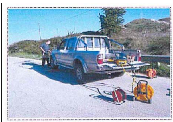
Fig. 15 – Postazione indagine sismica DH-S.2
