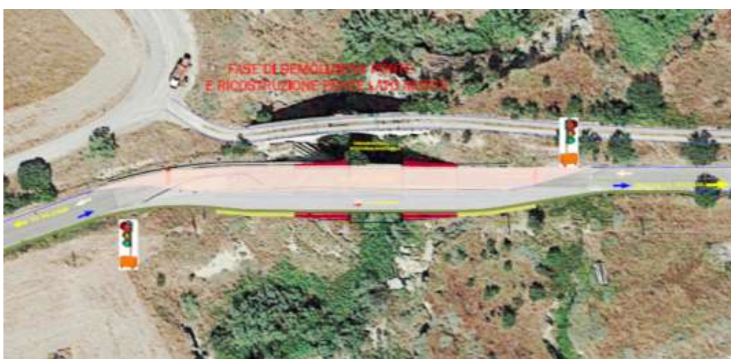
Traffico sulla nuova corsia e demolizione dell'attuale ponte con costruzione della corsia di monte
