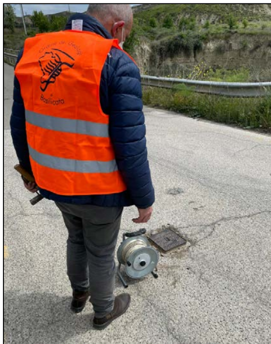
Fig. 14 – Misure nel piezometro del Sondaggio S1
