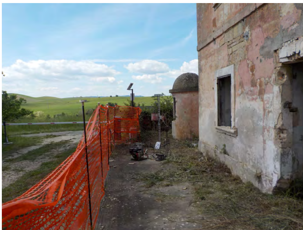
Foto n° 3 – Postazione prova penetrometrica PP.2
