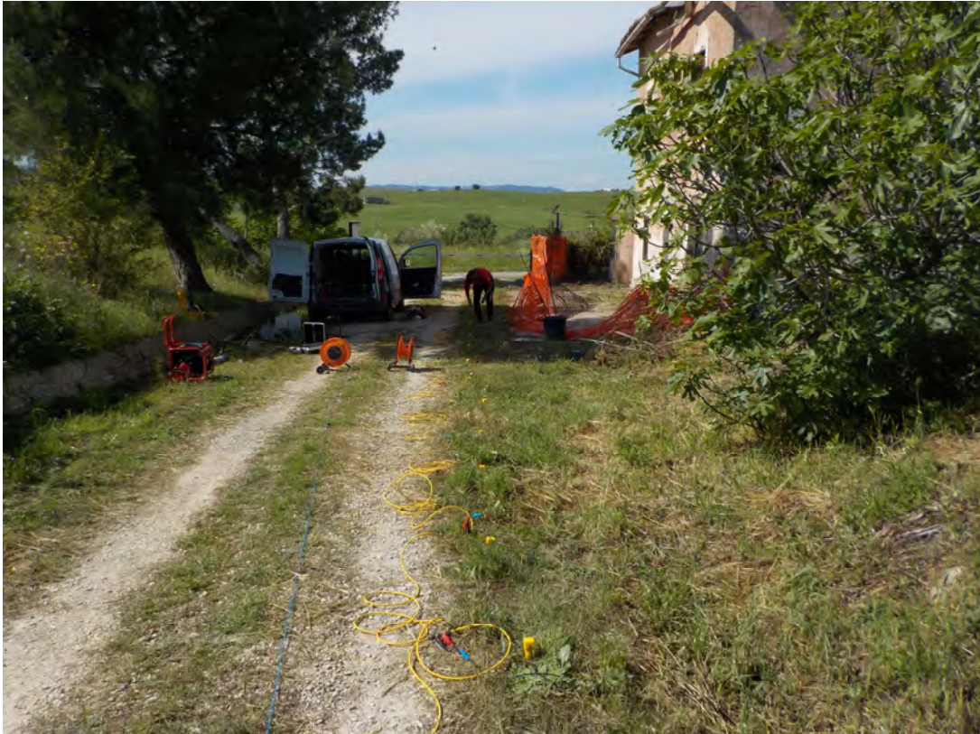
Foto n° 5 – Ubicazione prospezione sismica Masw (Laborgeo srl, 2019)
