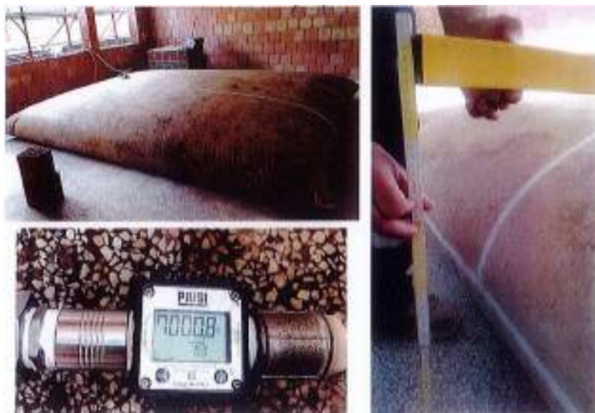
Fig. 40 Solaio di prova con dispositivo di carico
