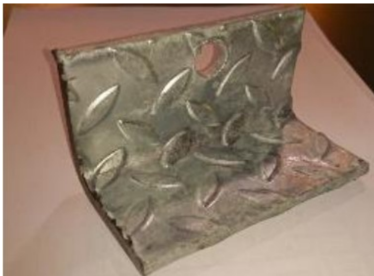
Fig. 3. Lavorazione della superficie interna della lamiera degli angolari
