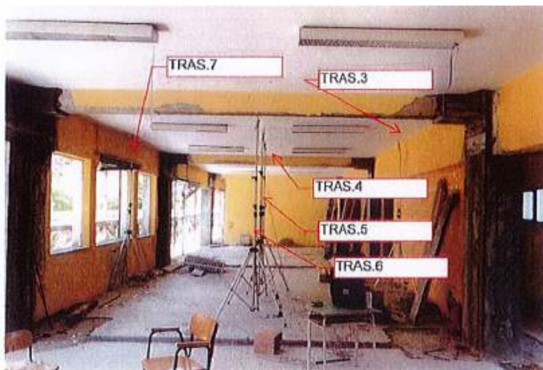
Fig. 41 Disposizione e numerazione dei trasduttori posti al piano terra durante la prova di carico statica
