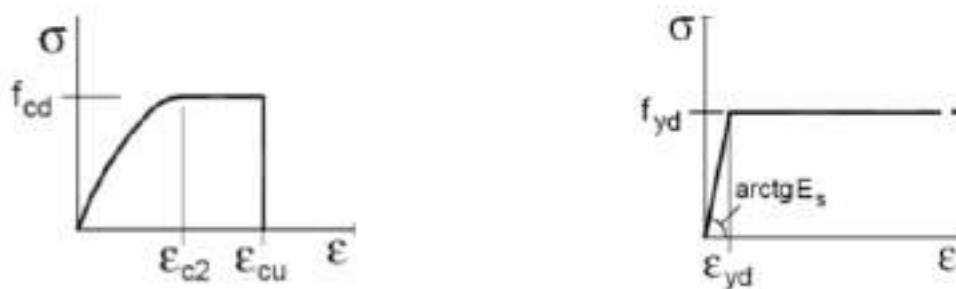
Fig. 19. Diagrammi di calcolo tensione/deformazione del (a) calcestruzzo e (b) dell'acciaio.
